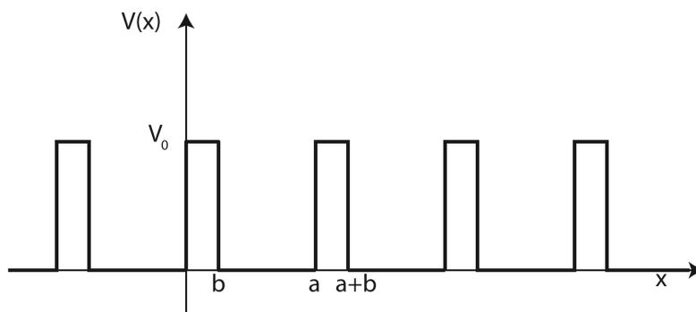
Das Kronig-Penney-Modell nähert das Potential für die Valenz-Elektronen in einem Festkörper durch Potentialtöpfe der Tiefe  $V_0$  und der Breite  $a - b$  an. Wir wollen dieses Modell unter der Vereinfachung lösen, dass man das Potential als  $\delta$ -Kamm schreiben kann mit
