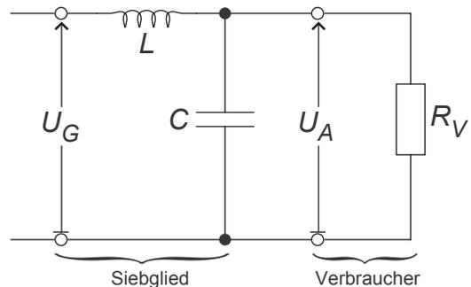
Berechnen Sie das Übertragungsverhalten  $U_A/U_G$  des skizzierten Siebgliebes. Hierbei ist der Verbraucher  $R_V$  zu berücksichtigen. Zur Abschätzung der verbleibenden Spannungsschwankungen („Restwelligkeit“) betrachten wir in der Fourierreihe nur den Term mit der kleinsten Frequenz  $m\omega_0 \neq 0$ . Wie groß ist die relative „Restwelligkeit“  $U'_m/U'_0$  der Ausgangsspannung
