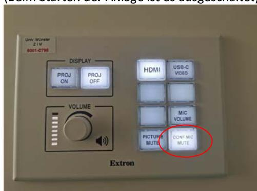
Das Handmikrofon geht nach einer gewissen Zeit selbständig an, wenn man es aus der Ladeschale nimmt. Alternativ lässt es sich auch über den Schalter (Siehe Bild) manuell einschalten.
